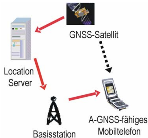
Abb. 9: Grundprinzip der Assistenzfunktion (A-GPS)
